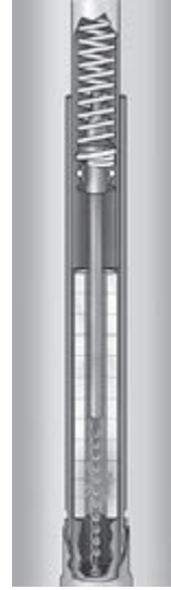
La varilla se desplaza, alargando el arco y vaporizando el ácido bórico.
